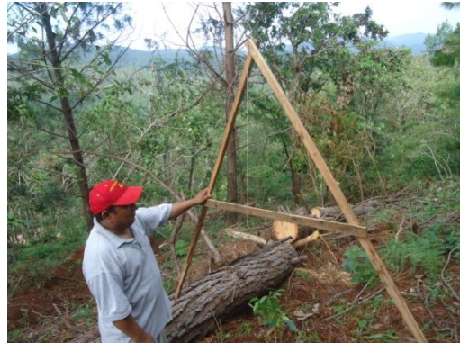
Trazo de curvas a nivel y realización de barreras muertas
